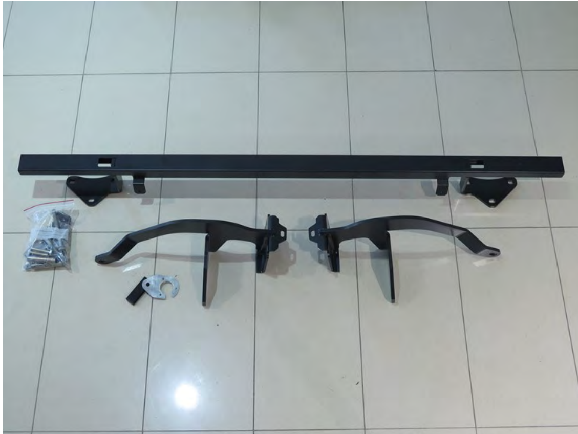
Variante 2. Querträger mit Anhängerkupplung / traversa con gancio di traino
