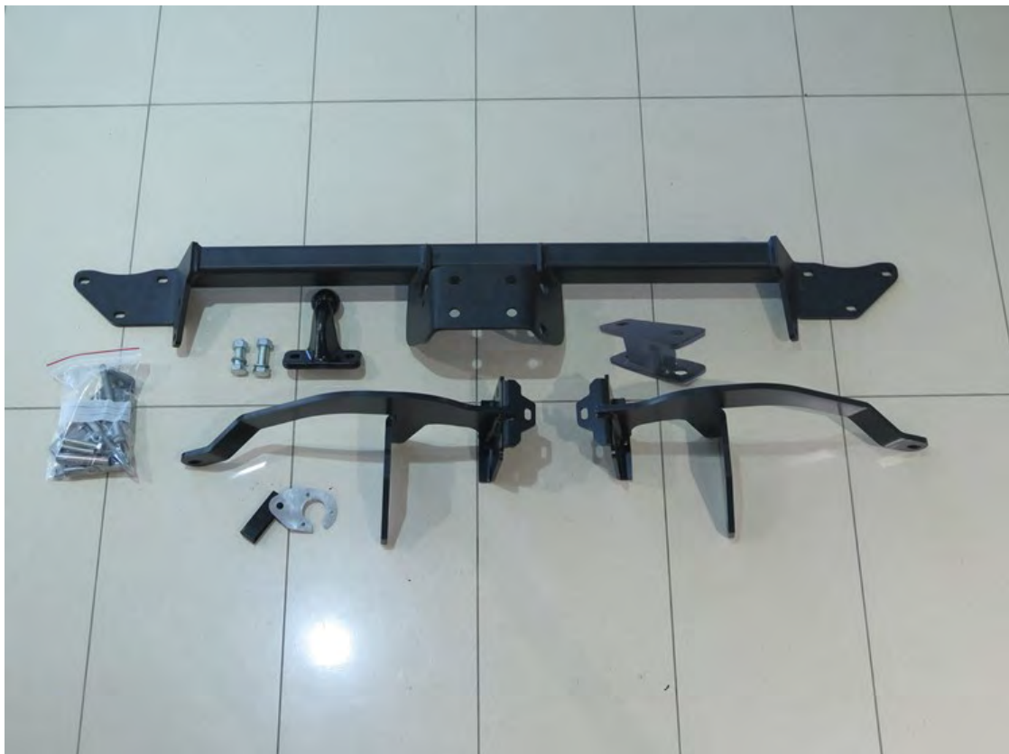
Variante 2. Querträger mit Anhängerkupplung / traversa con gancio di traino
